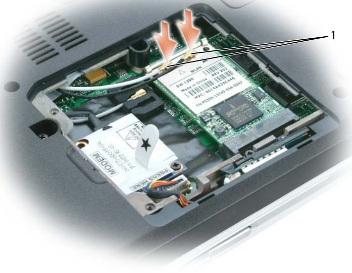
1 Cables de antena (2)
